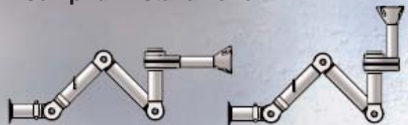
Installazione a parete. Attacco rivolto verso l'alto.
